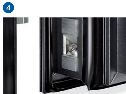
Stabile Eckverbindungen Profile auf Gehrung verschraubt, verklebt und verbolt
